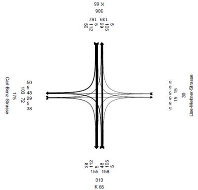
Nachmittagsspitzenstunde<sup>3</sup> [Kfz/h] des bestehenden Knotenpunktes von 15:30 Uhr bis Abbildung 3: 16:30 Uhr im Prognosefall 2025
